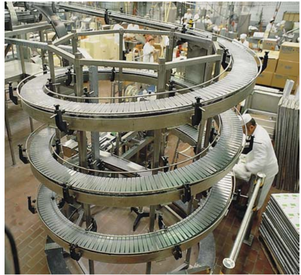
Spiral-Förderer für empfindliche Verpackungen Spiral Conveyor for extreme fragile packagings
