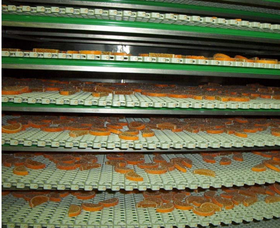
Durchlaufkühler mit Fruchtgelee-Stücken Cooling-system for fruit jelly pieces
