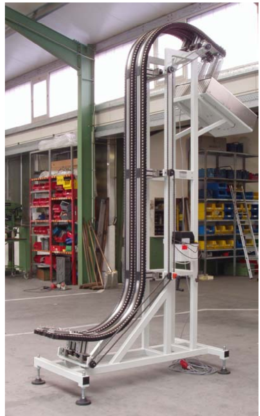
Vertikalförderer mit schmaler Mitnehmerkette für Preforms mit Ø 16 mm
