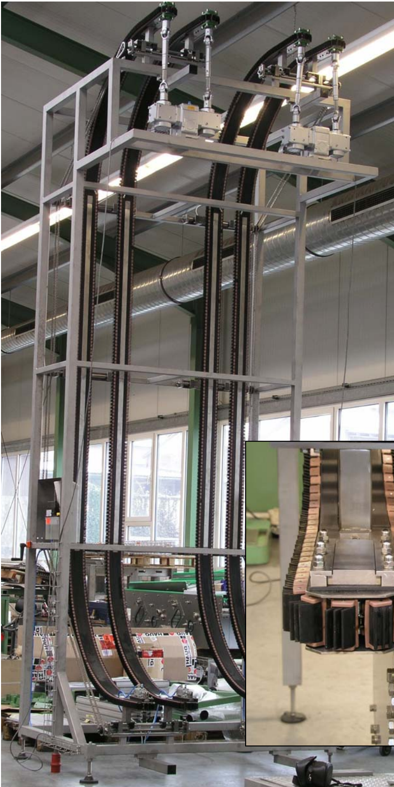
Vertikalförderer mit schmaler Mitnehmerkette für Glasflaschen
