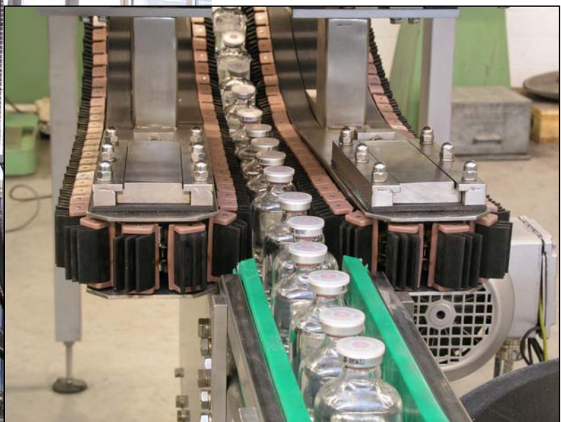
Vertikalförderer mit schmaler Mitnehmerkette für Glasflaschen
