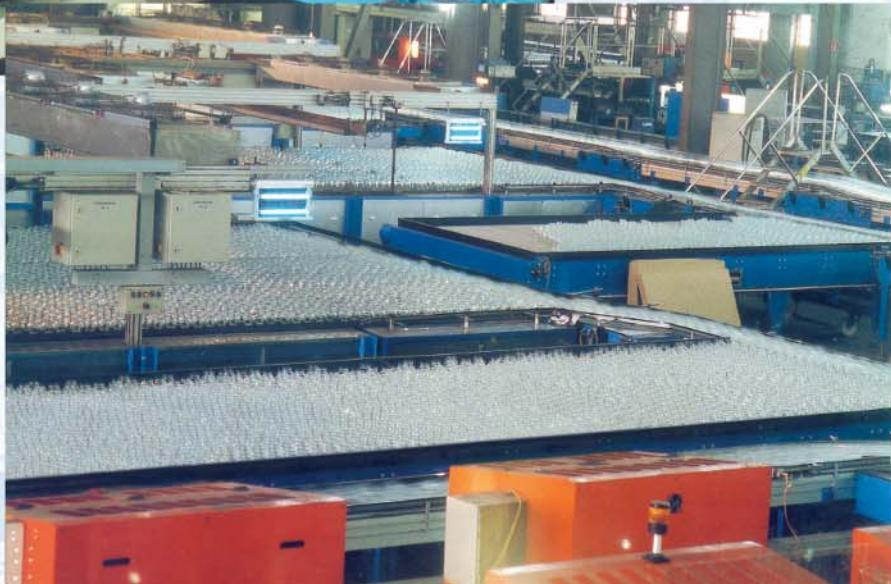
Stautische nach der Kühlbahn überbrücken Stillstandzeiten bei Störungen.
