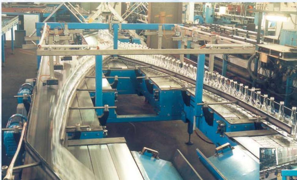
Unterschiedliche Bandgeschwindigkeiten führen produktschonend vom Pulk- zum Einzelstrom.
