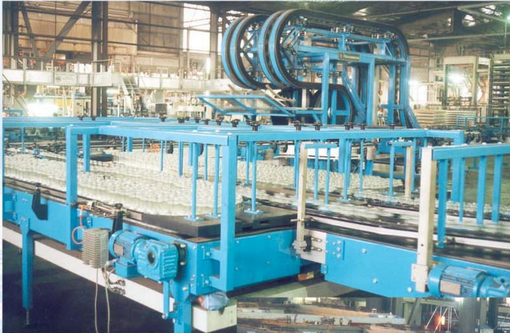
Verteiltsche zur individuellen Aufteilung auf mehrere Prüfstränge. Gegenläufig angeordnete Förderbahnen verhindern Staudruck und ermöglichen eine kurzfristige Zwischenpufferung.
