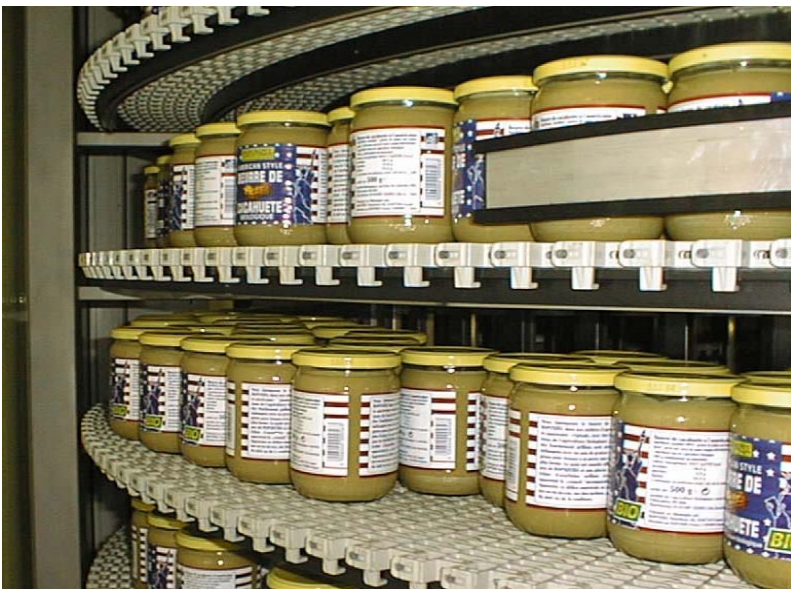
Durchlaufkühler mit Nußnougat-Gläser Cooling-system for glass jars with chocolate cream
