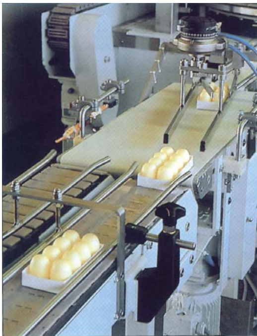
Verteilstation für befüllte Papp-Trays Distribution Device for filled carton trays
